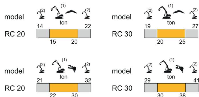
(1) Optimale Bagger-Ausrüstung Kombination
